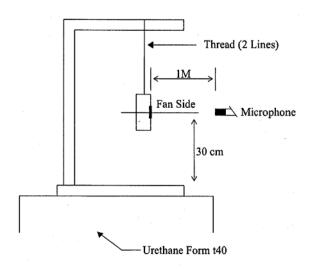
1 METER FROM MICROPHONE TO FAN INTAKE
