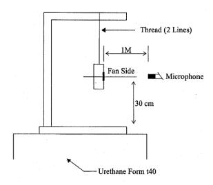
1 METER FROM MICROPHONE TO FAN INTAKE
