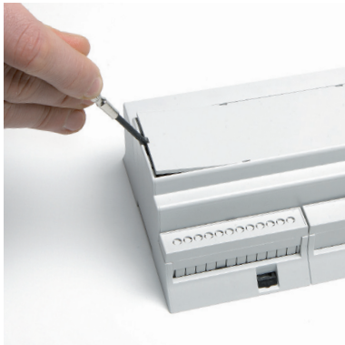
Rimuovere il pannello Remove the panel
