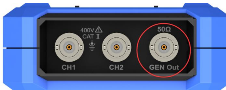
图 5-1: Generator Output Ports
