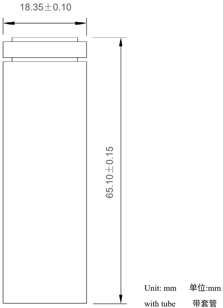
**Fig. 1. Outline Dimensions of INR18650/35V****图 1.INR18650/35V 外形尺寸**
